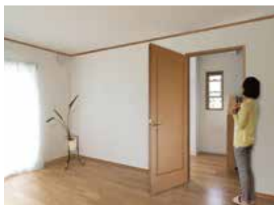
従来のドアの空間 (H2,000mm) 下がり壁があることで、天井を区切ってしまう為、 開放感がなくお部屋が狭く見えます。
