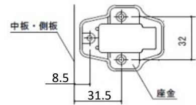
扉を吊込用治具の上に載せ、中板・側板に近づけて座金取付位置を確認し下穴を開ける
