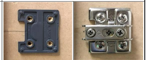
扉を吊込用治具の上に載せ、中板・側板に近づけて座金取付位置を確認し下穴を開ける
