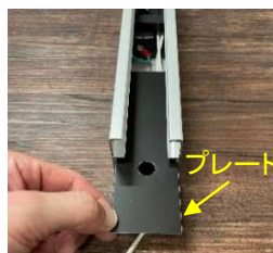
戸先側より プレートを抜く
