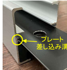
プレートをプレート穴とレール取付穴の 位置を合わせて元通りに差し込む ※プレートは奥まで差込と戸先側に隙間が空きます
