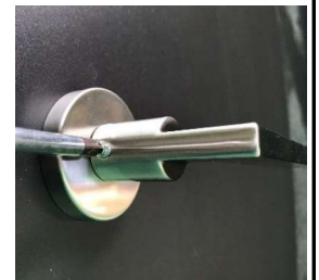
両側から押し付けながら手動+ドライバーでネジ締め
