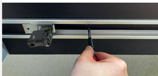
①手動ドライバーでビスを半回転程緩める
