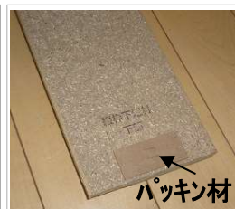
縦枠下地の下部裏側に2mm厚パッキン材取付済
